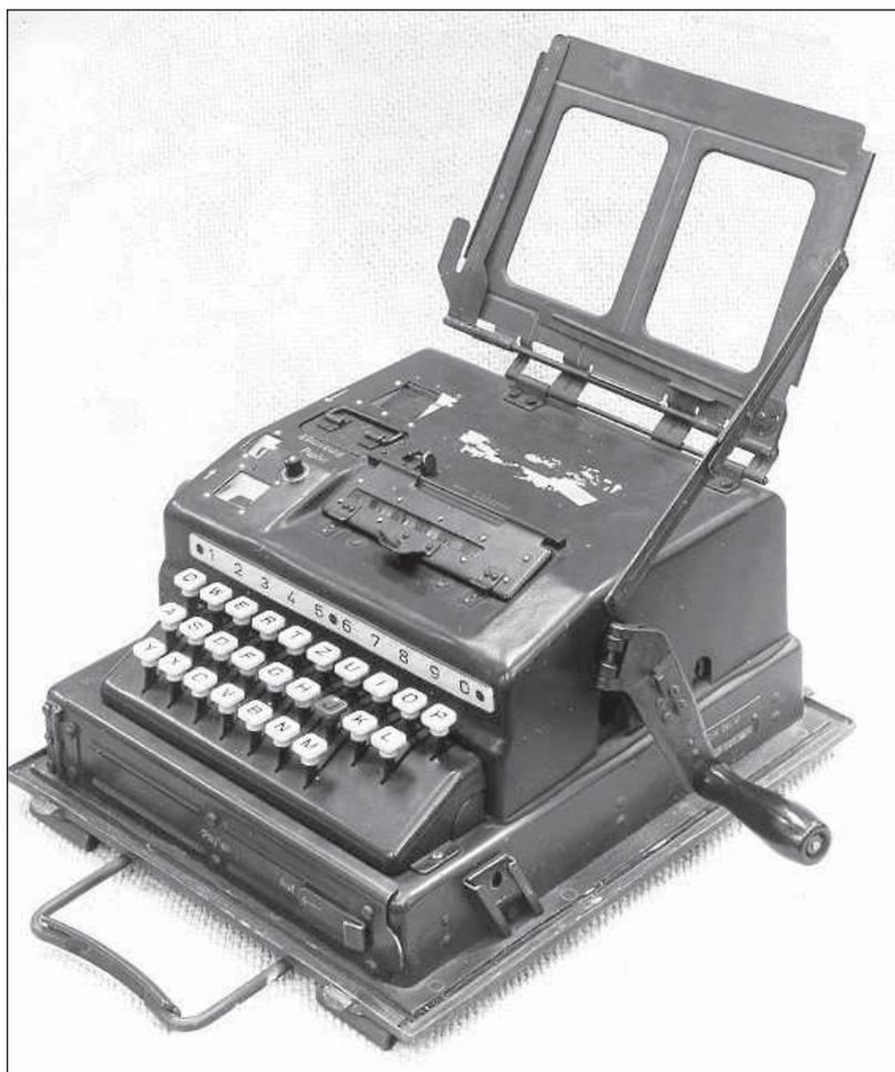
Fig. 19. Schlüsselgerät 41 ready for use
