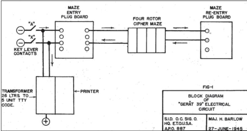
Fig. 17. SG-39 electrical circuits
